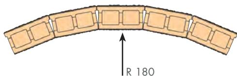
Courbes visibles sur deux faces. Rayon intérieur 180 cm. Il se construit avec les blocs de courbes.
